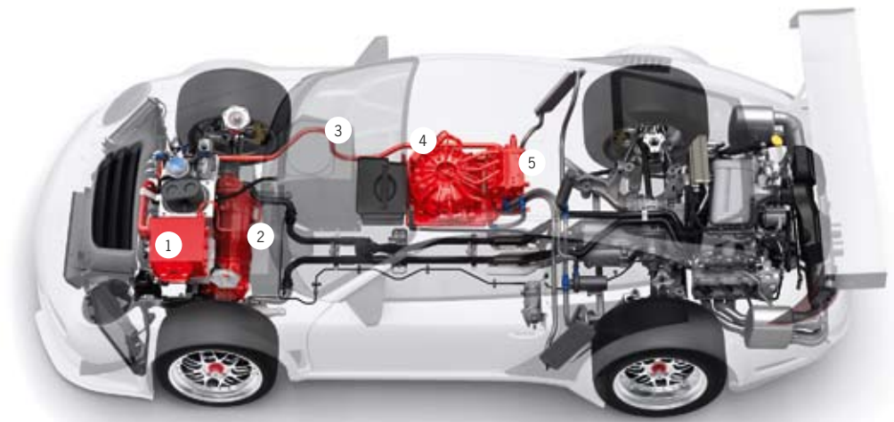
Hybrid-Komponenten im 911 GT3 R Hybrid
