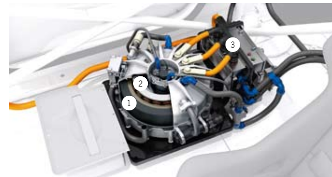
Schwungradspeicher im 911 GT3 R Hybrid
